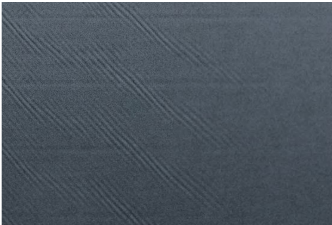
Bild 9.4.4 Tvärgående märken från anslutningen till dukröret och synliga skarvar kan uppstå på duken, se 4.2.7.
